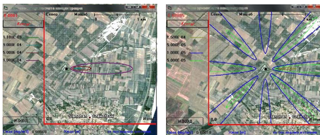
Фигура №. 13 Моделиране разсейването на прахови частици от изпускащото устройство на инсталацията при преобладаващ за района вятър и в съответствие с розата на ветровете
