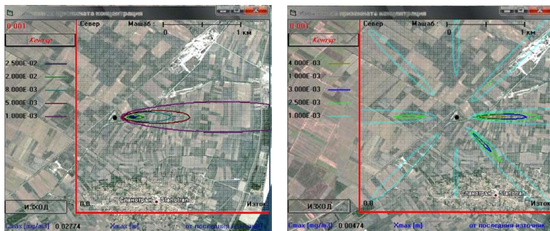
Фигура №. 10 Моделиране разсейването на \text{SO}_2 от изпускащото устройство на инсталацията при преобладаващ за района вятър и в съответствие с розата на ветровете – I вариант
